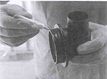
Etape 7- Mettre de la graisse (6) sur le joint du coude d'aération Ø70 (8).
